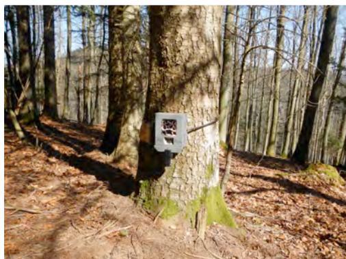
**Figure 3** : Illustrations d'un appareil Cuddeback Ambush (flash ; à gauche) posé sur le terrain pour le suivi ponctuel « WUESTENBERG » et d'un appareil Reconyx HC600 (infrarouge ; à droite) posé sur le terrain pour les suivis ponctuels « BELFAYS » et « FOUCHY » (© CROC).
