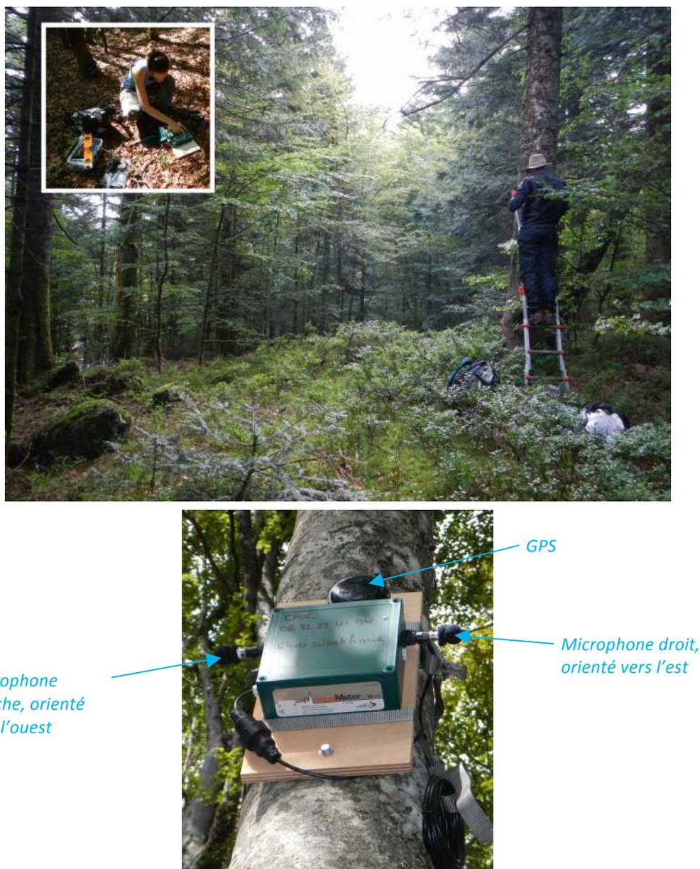
**Figure 15** : En haut, pose d'un piège à son sur le secteur « Ventron » (chargement du paramétrage depuis la carte mémoire, puis installation sur un arbre ; en bas, appareil « S02 » prêt à enregistrer (août 2013 ; © CROC)
