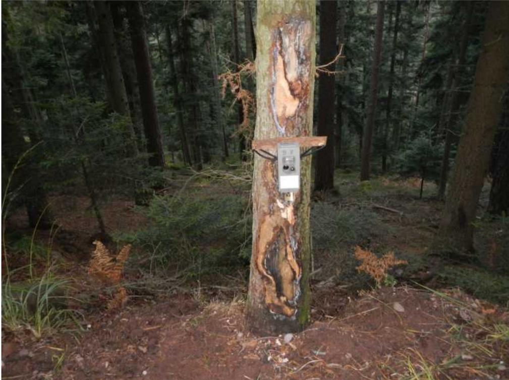
**Figure 5** : Illustration n°1 d'un dispositif de piégeage photographique installé à l'aide d'un bout de bois afin de bien caler le caisson (© CROC)
