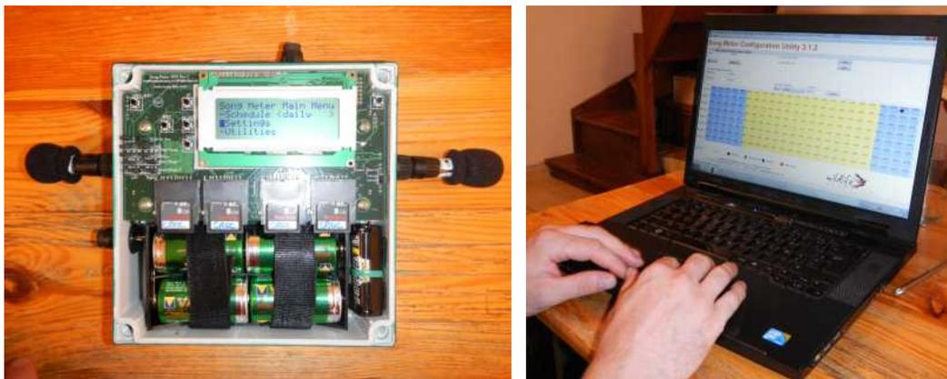
Figure 14 : Illustration d'un piège à sons et du paramétrage des cartes mémoires avant la pose sur le terrain
