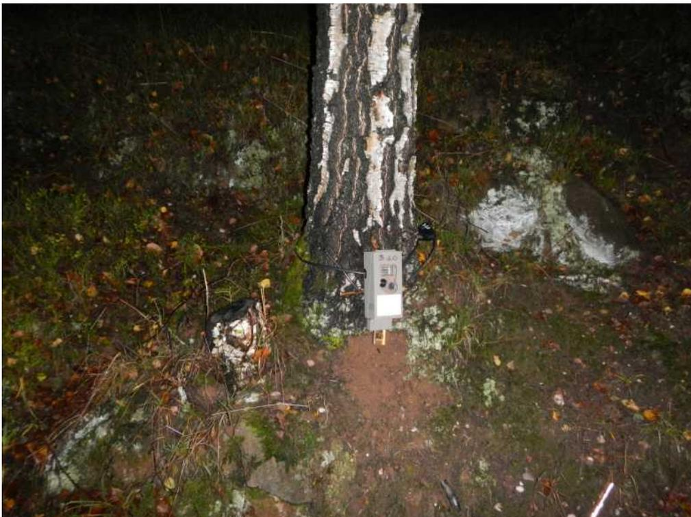
**Figure 6** : Illustration n°2 d'un dispositif de piégeage photographique installé à l'aide d'un bout de bois afin de bien caler le caisson (© CROC)
