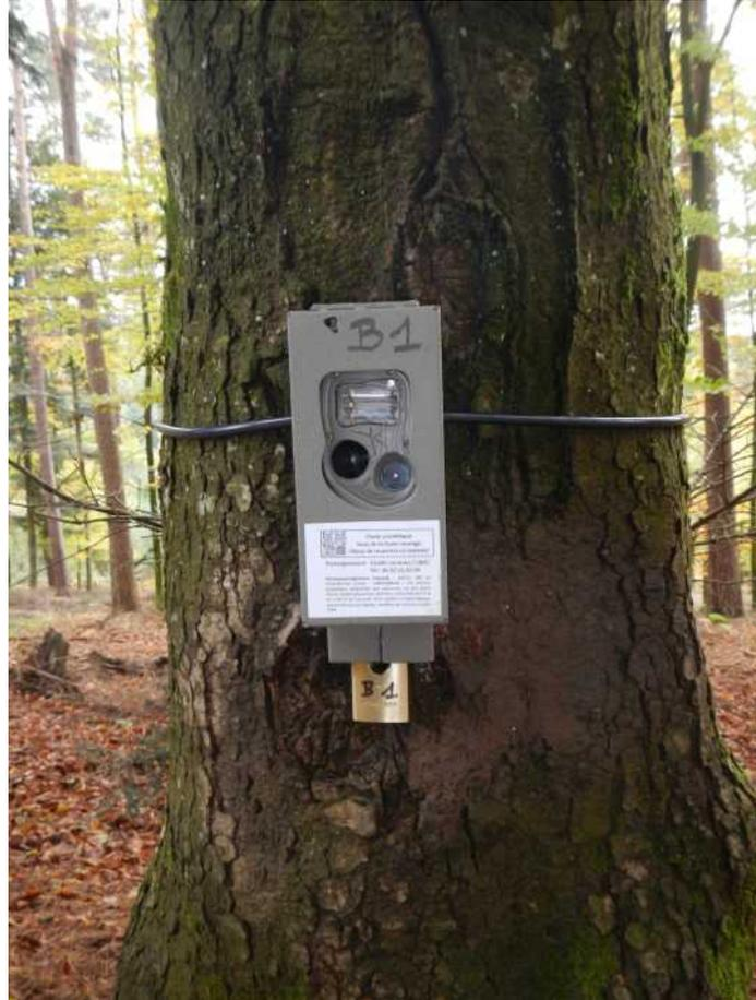
**Figure 3** : Illustration d'un dispositif de piégeage photographique posé sur le terrain. On distingue le caisson métallique sur lequel une affiche d'information est collée. Ce caisson métallique est fixé à l'arbre avec un câble Python (câble noir). Le piège photographique est enfermé dans le caisson métallique avec un cadenas à anse protégée (© CROC)
