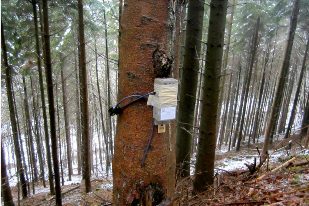
**Figure 10** : Illustration de l'appareil B28 dont l'objectif a été scotché empêchant le fonctionnement de l'appareil pendant quelques jours. L'appareil a été laissé sur le terrain (© CROC)
